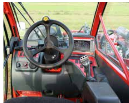
Voznikovo delovno mesto na levi strani vozila. Večino funkcij krmili z večnamensko ročico, nastavitve pa izvaja na krmilnem prikazovalniku, ki je nameščen desno pred volanom.
