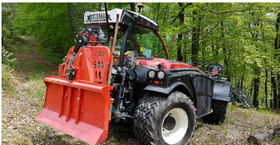
Grip4 ima več možnosti krmiljenja koles. Na sliki vidimo štirikolesno krmiljenje. Vsa priklopna mesta zadaj so standardne izvedbe (hidravlično dvigalo, priklop za vleko, hitre spojke). Foto Nejc Jančar.
