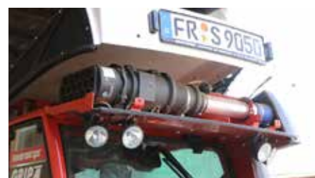
Zračni filter za motor ima Grip4 nameščen pod pokrovom strehe kabine. Zrak vsesa na mestu, kjer je pri delu najmanj prahu. Za vzdrževalna dela pokrov enostavno dvignemo.
