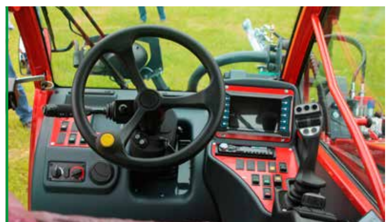
Entièrement indépendante du châssis, la cabine du Grip4 constitue un habitacle insonorisé à 72 dB.
