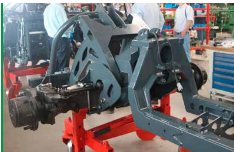
Le secret de la stabilité du tracteur en pente: un essieu sur châssis pendulaire.
