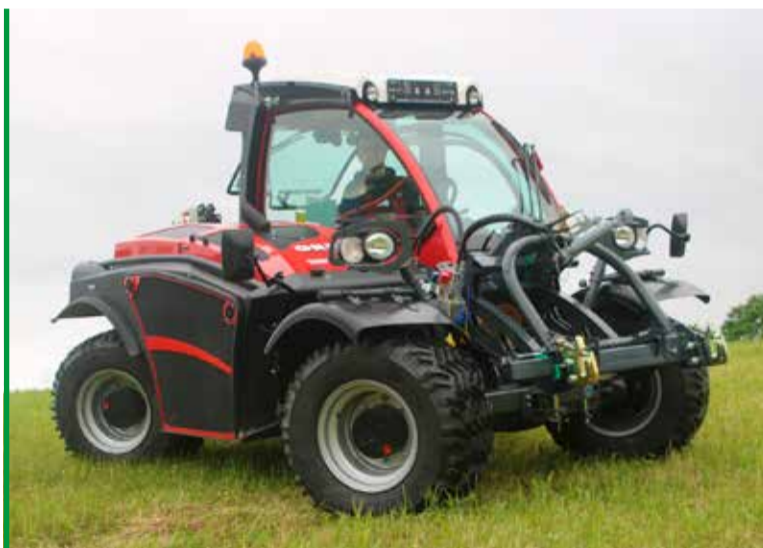
Le tracteur porte-outils de montagne Grip4 est extrêmement stable grâce à son essieu pendulaire.
